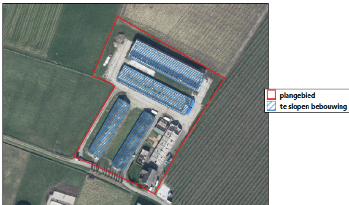
Te slopen bebouwing binnen het plangebied
