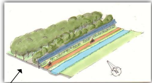
geluidswand A15 met zonnepanelen en fietspad RijnWaalpad
