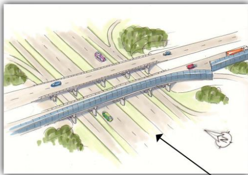
geluidswand brug A 15 met zonnepanelen
